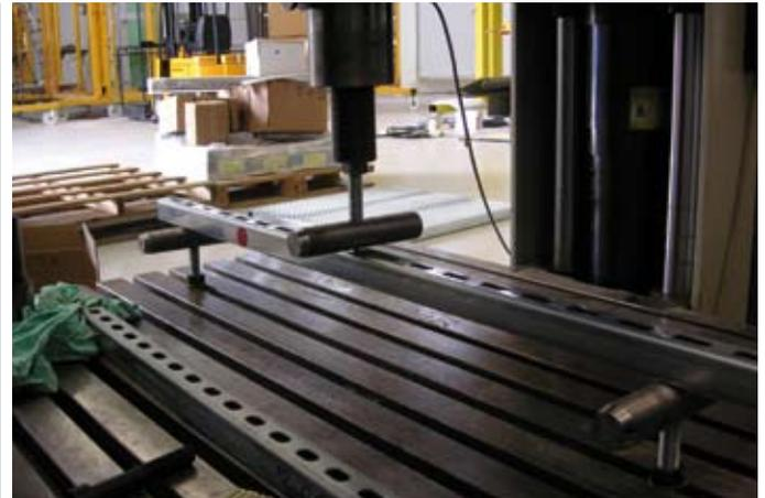
**Bild 1:** Die Gütesicherung von Montageschienen nach RAL-GZ 655 führt zu mehr Sicherheit beim Einsatz von Montageschienen
