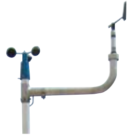
Sensorstation: Windrichtungssensor erspart mehrere Windsensoren
