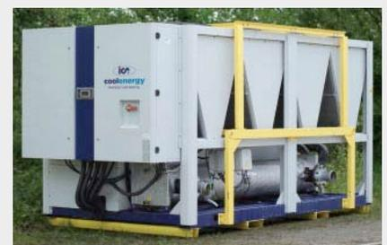
Low-Noise-Ausführung (SN) – leise Ausführung. Die niedrigen Schallwerte werden durch eine spezielle Schallisolierung des Verdichtergehäuses und durch niedrigere Drehzahlen der Ventilatoren erzielt.
