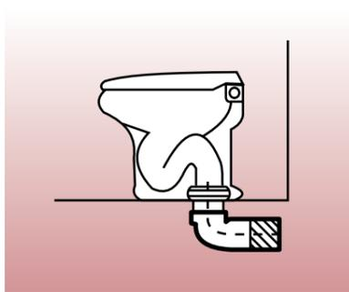
1. Stand-WC mit verdecktem senkrechten Abgang. Anschluss an einen gusseisernen WC-Anschlussbogen mit einem Klosettanschlussstutzen aus Kunststoff.
