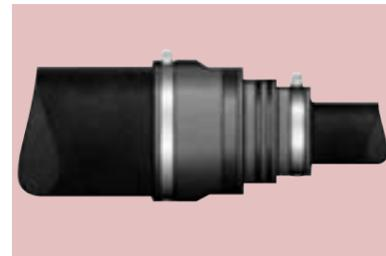
3. Auf einen einwandfreien, sauberen Zustand der Dichtzone (Spitze der Rohre bzw. Formstücke) ist zu achten. Farbnaesen oder Zementreste sind mit Sandpapier vollständig zu entfernen.
