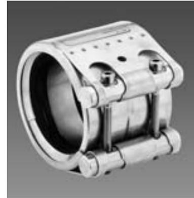
Connect-F: nicht längskraftschlüssig; druckstabil bis 10 bar, wenn Axialkräfte durch Festpunkte aufgenommen werden.
