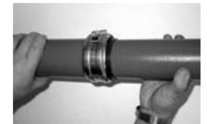
3. SML-Rohr oder Formstück DN 70 mit Schlauchstück in den Verbinder DN 80 einschieben
