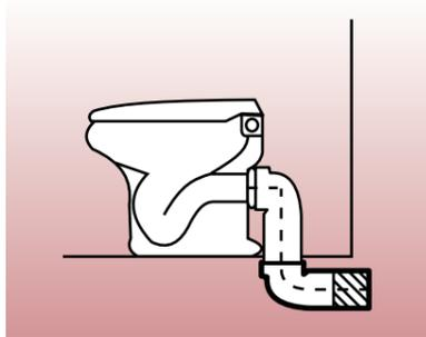
2. Stand-WC mit waagrechttem Abgang. Anschluss an einen gusseisernen WC-Anschlussbogen mit einem Klosettanschlussbogen mit 90° aus Kunststoff.
