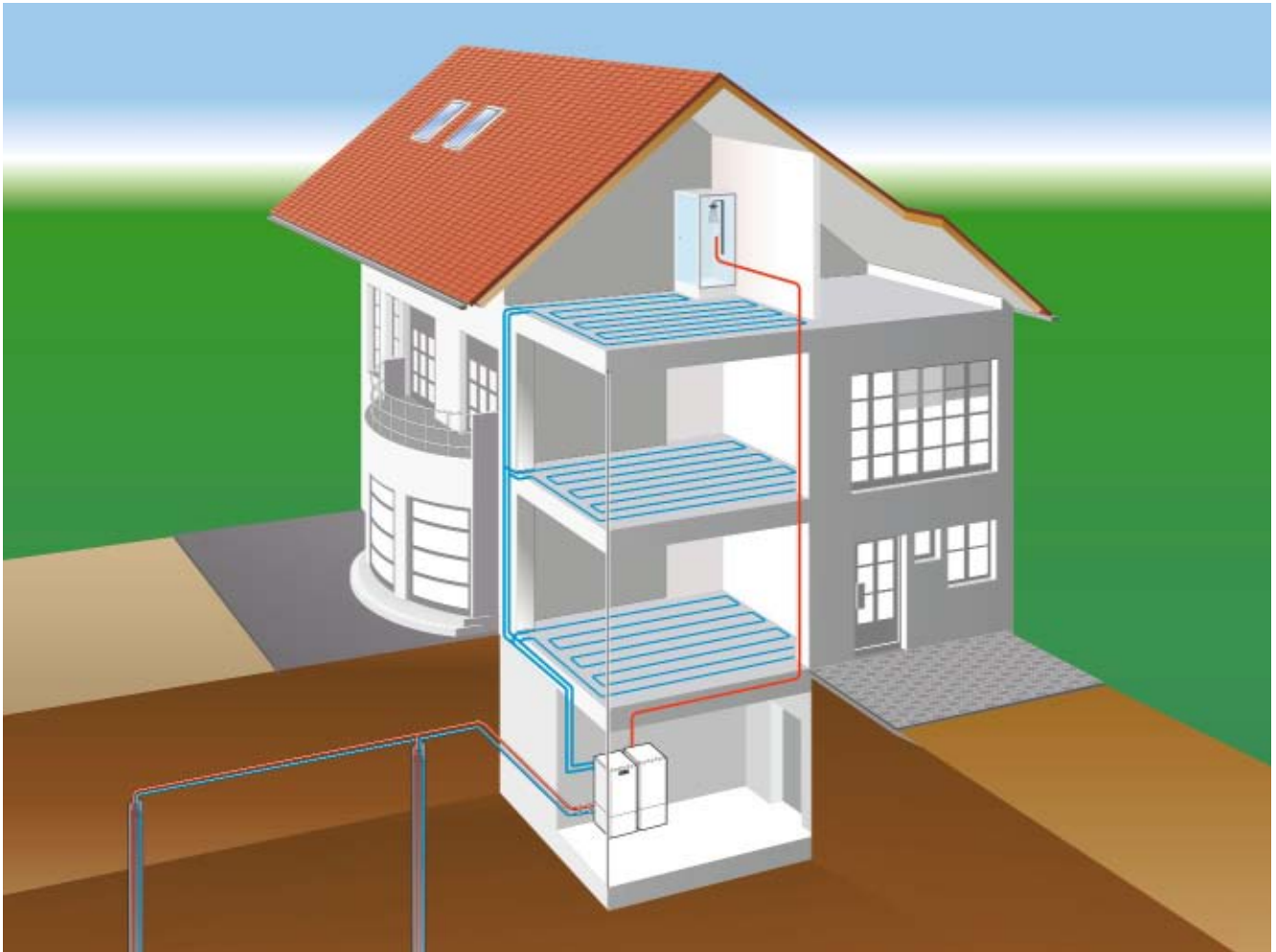
Beispiel für die passive Kühlung mit einer Sole/Wasser-Wärmepumpe
