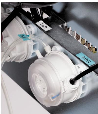
Abgas- und Luftdruckwächter sorgen für sicheren Betrieb
