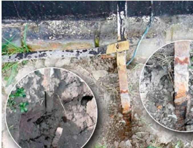
Bild 2: Korrodierter Erder nach ca. 30 Jahren
