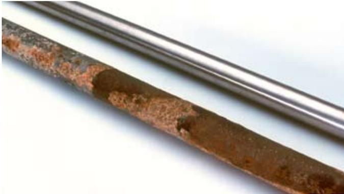
**Bild 4: Korrosionsbeurteilung Tiefenerder verzinkt (unten) und Tiefenerder hochlegierter Edelstahl (oben), Einbauzeit: 2,5 Jahre**
