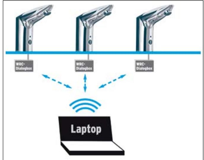
Die Zusatzausstattung der Standarmatur umfasst eine WRC-Dialogbox sowie einen WRC-Controller; die WRCDialogbox übernimmt als Verbindung von der Armatur zum WRC Controller Kommunikation und Betrieb, die zentrale Steuerung und Überwachung aller im Raum befindlichen Armaturen dieser Serie
