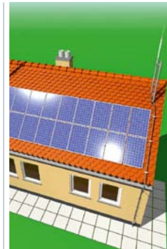
Bild 3: Trennungsabstand Wohngebäude mit PV-Anlage => Beispiel: 2 Fangmaste mit isolierter Ableitung
