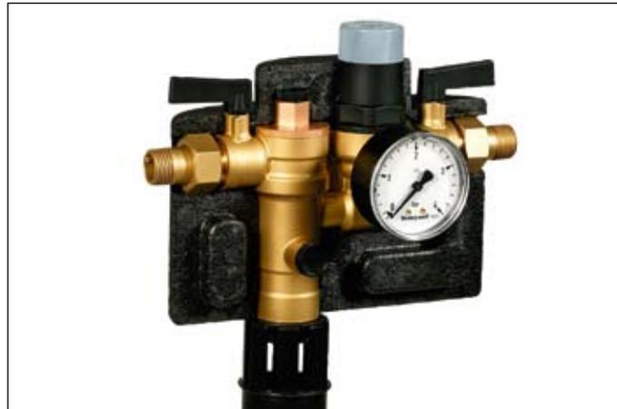
**Bild 2: Nachfüllkombinationen wie die „NK 300“ bestehen meist aus einem Systemtrenner zur Absicherung und einem Druckminderer zur automatischen Nachspeisung des Heizungsfüllwassers**
