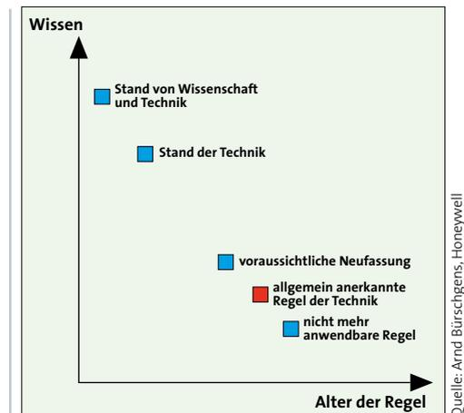
**Bild 1: aaRdT – allgemein anerkannte Regeln der Technik: Nicht bloß auf Grund des Bestehens werden Normen zu anerkannten und anwendbaren Regeln der Technik; die Aktualität und Akzeptanz des zugrunde liegenden Wissens spielen eine maßgebliche Rolle**
