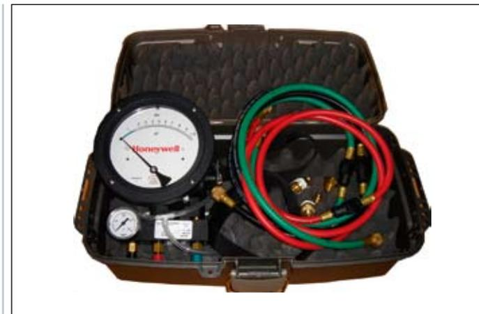
**Bild 6: Differenzdruck-Messgerät: ein Bypass mit Nadelventilen ermöglicht die Prüfung sämtlicher Komponenten der Systemtrenner**
