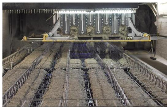
Bild: Kapillarrohrmatte unter der Bewehrung im Betonwerk eingelegt
