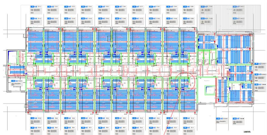
*Bild: Deckenspiegel mit Rohrsystem und Freiflächen für Vorrichtungen*
