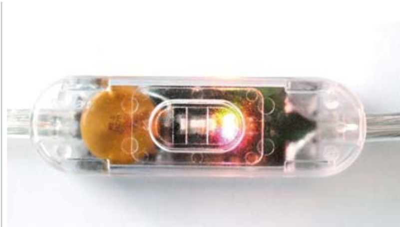
Weltkleinster Schnurdimmer dank dS-Chip (Prototyp)
