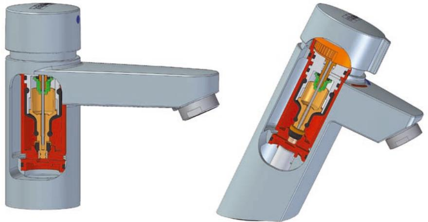
Das sicher eingebettete Selbstschluss-Funktionselement garantiert durch seine kolbenlose, verschleißarme und selbst reinigende Arbeitsweise eine hohe Lebensdauer der Armatur. Die Betätigungsgriffe der Ganzmetallarmaturen sind mit einer abriebfesten Farbmarkierung versehen.
