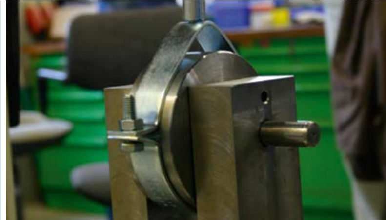
Bild 1: Das klassische Befestigungselement zur Befestigung von Rohren ist in Deutschland die Rohrschelle
