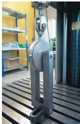
Bild 3: Prüfung einer Rohrschelle (Zugprüfung)
